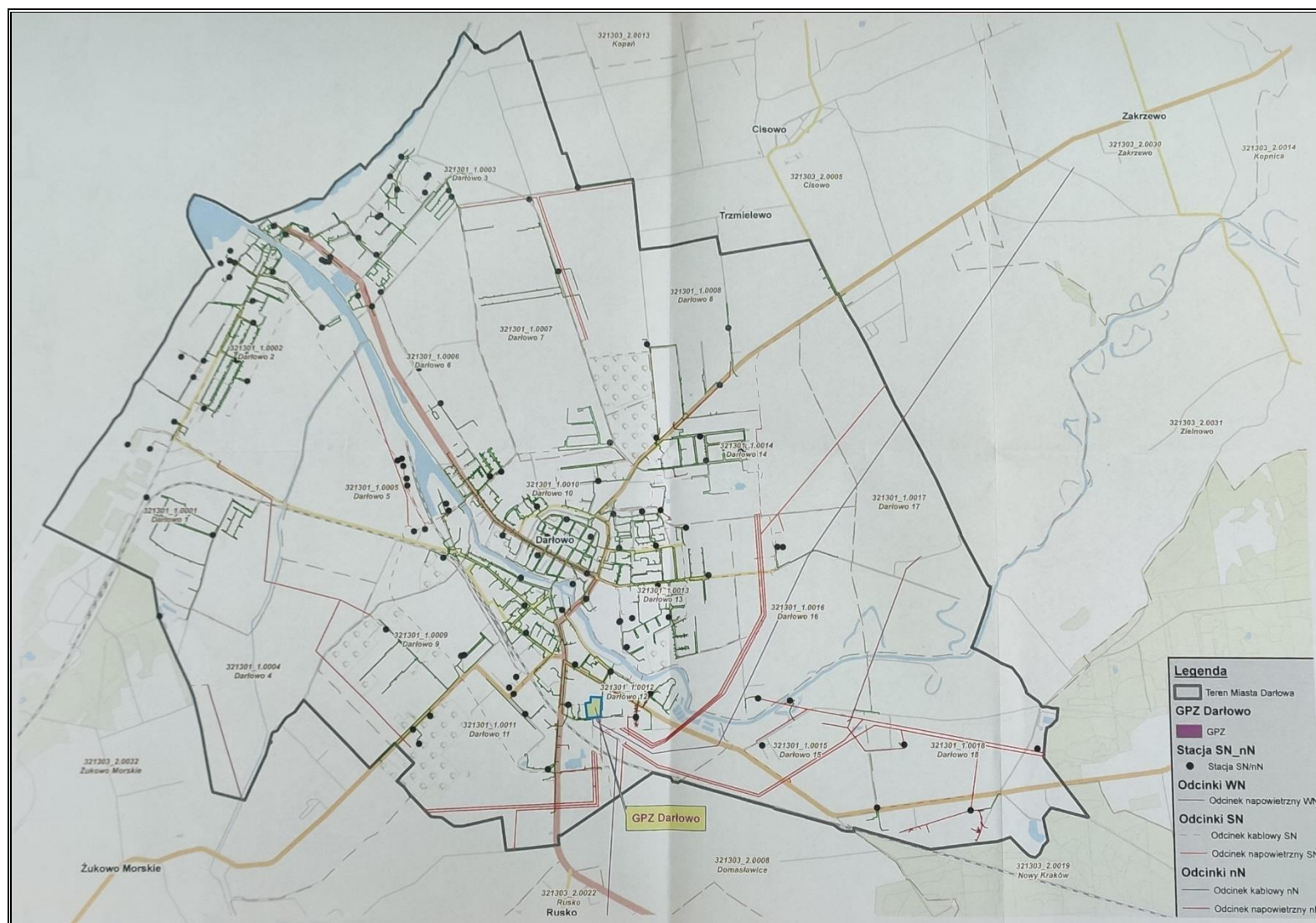
Rysunek 6. Plan rozmieszczenia sieci elektroenergetycznych oraz stacji transformatorowych na terenie miasta Darłowo
