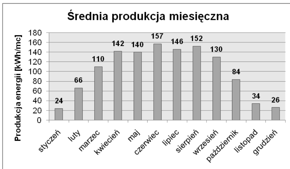
Wykres 9. Produkcja energii elektrycznej przez panele fotowoltaiczne
